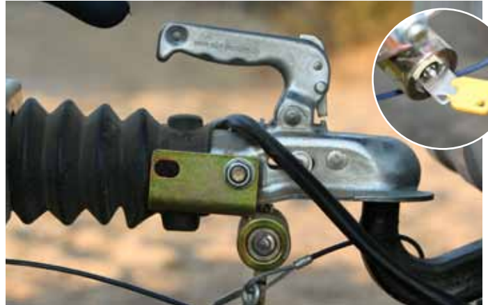
Verschluss-Sache: Sicherung gegen Langfinger – Schlüsselummantelung etwas labil.
