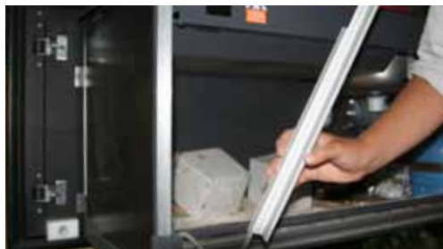
Bruchstück: Im Offroad-Einsatz machte sich unsere Küchenzeile selbstständig – vom Hersteller wurde nachgebessert.
