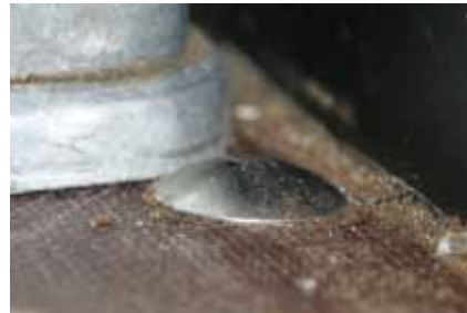
Blockiert: Nicht versenkte Linsenkopfschrauben.
