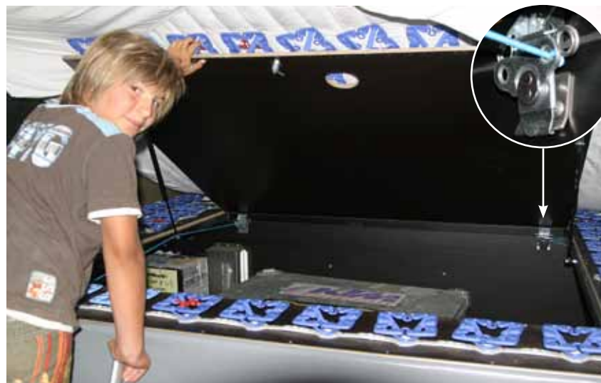
Variable Beladung: Der Hänger von 3DOG kann sowohl von außen (Heckklappe aufklappen) als auch – Vorteil bei schlechtem Wetter – vom Zeltinnern aus beladen werden (Liegefläche nach oben klappen).
