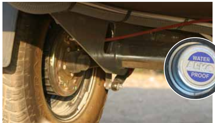
Damit's hält: Wartungsfreie, extrem stabile Gummifederachse von Top-Lieferant AL-KO.
