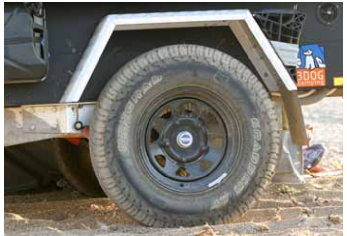
AT-Schuhwerk: Die groben Wrangler werden standardmäßig in 235/85 R 16 geliefert.
