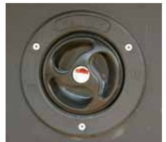
Überall mobil: In die Bordwand eingelassener Einfüllstutzen fürs Wasser.
